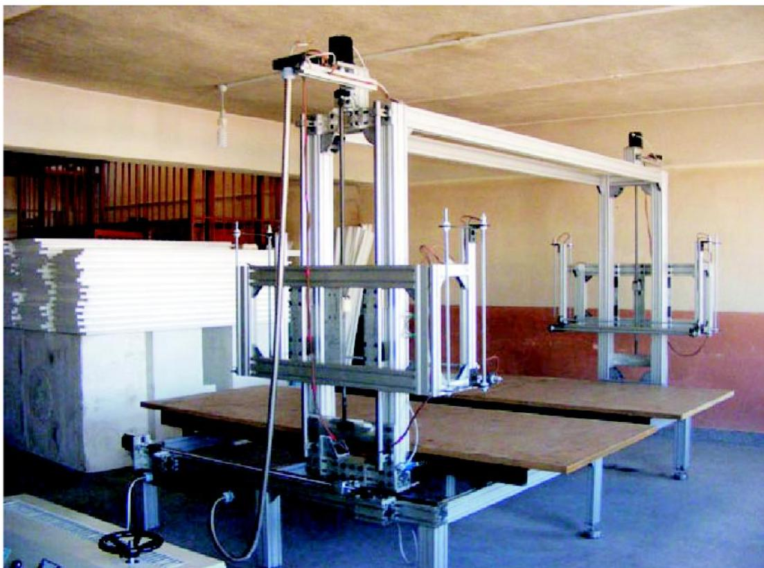
Машина для резки пенопластика
